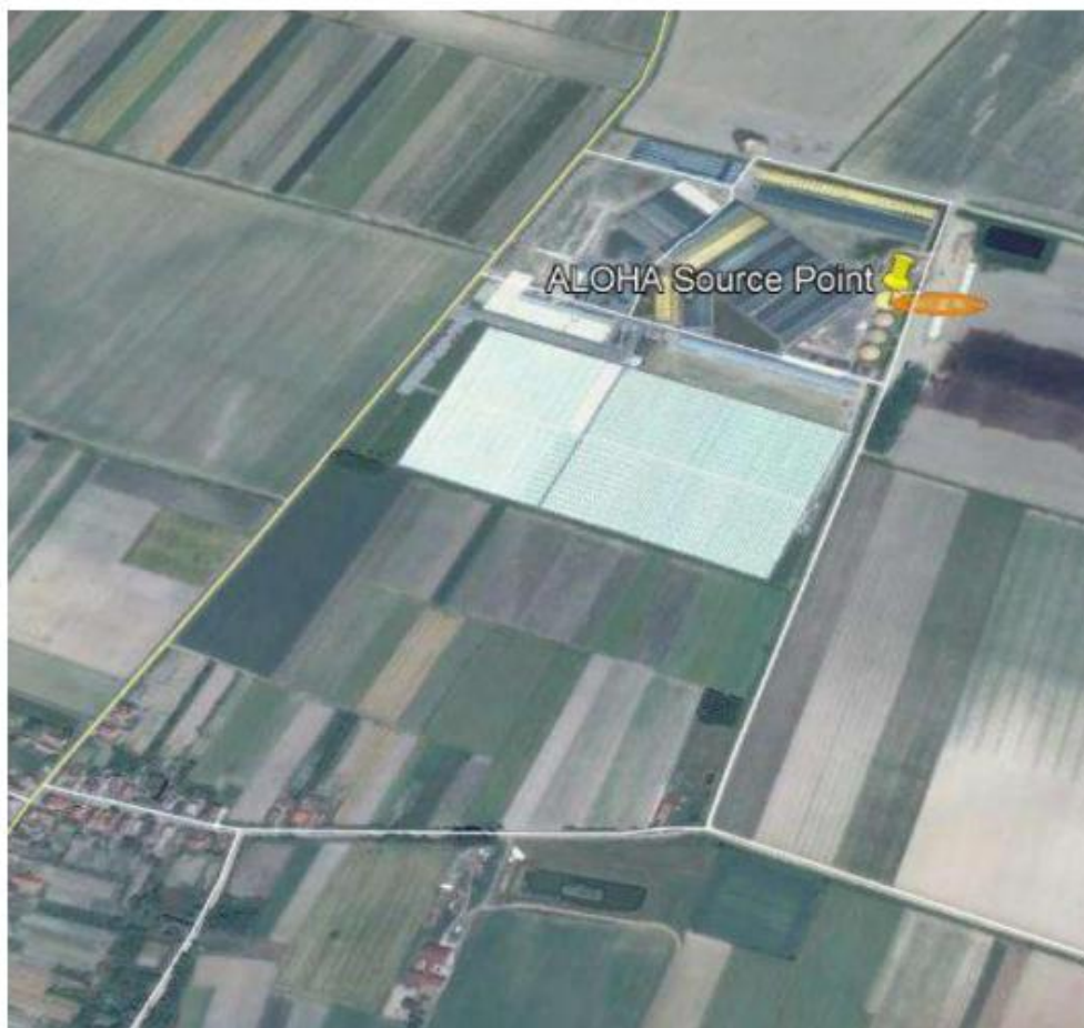
Slika 6-34 – Prikaz zone ugroze u slučaju ispuštanja bioplina – Izvor Procjena 2018.
